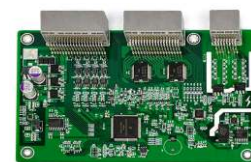
BMS 电池管理系统
