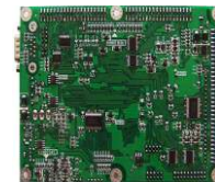
High Voltage Variable Frequency Control Panel 高压变频控制板
